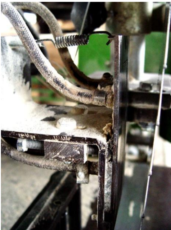
Рис. 6. Общий вид отжимной аэростатической направляющей, установленной в узел резания ленточнопильного станка FORESTOR 900 (для наглядности у пилы снято натяжение, и она отведена от направляющей)
