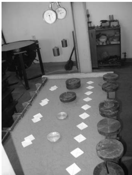
Рис. 4. Фрагмент испытаний моделей конических фундаментов на объемном стенде
